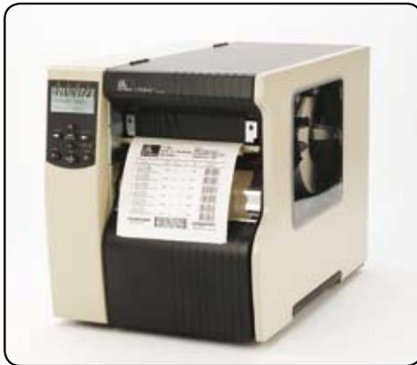
Принтер 170Xi4 наилучшим образом подходит для печати больших объемов этикеток соответствия AIAG, ODETTE, UCC/EAN-128 и других стандартов. Благодаря печатающей головке с разрешением 8 и 12 точек/мм этот принтер может распечатывать этикетки шириной до 168мм на скорости до 305 мм в секунду. Как и все принтеры серии Xi4 эта модель выполнена в прочном стальном корпусе и готова для работы в любых промышленных условиях.
